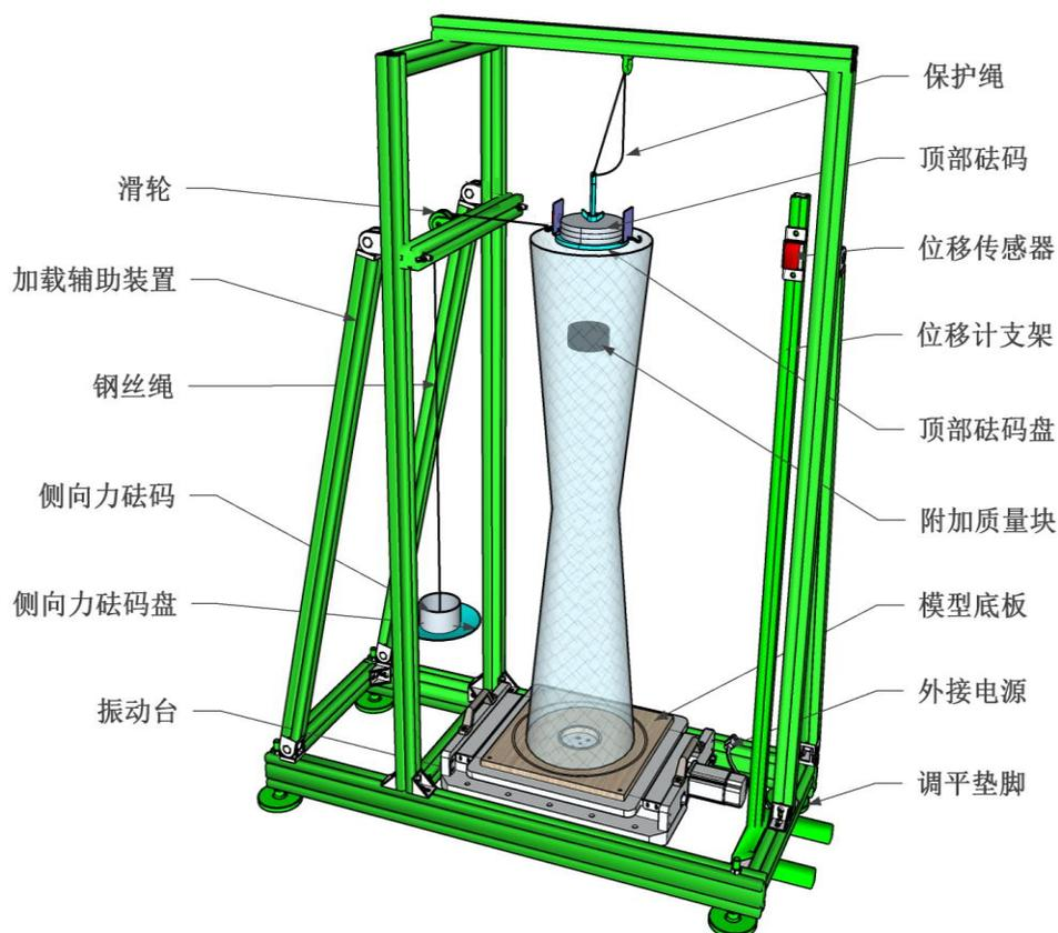
图 2 模型及加载装置示意图
