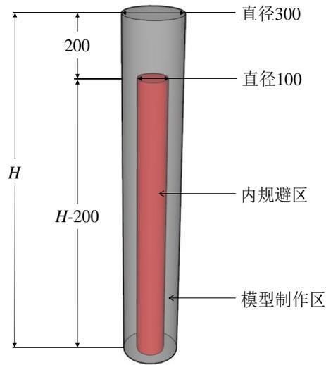
图 3 模型制作空间（灰色部分，单位：mm）
