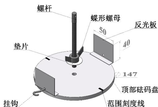
图 5 顶部砝码盘及附属配件（单位：mm）
