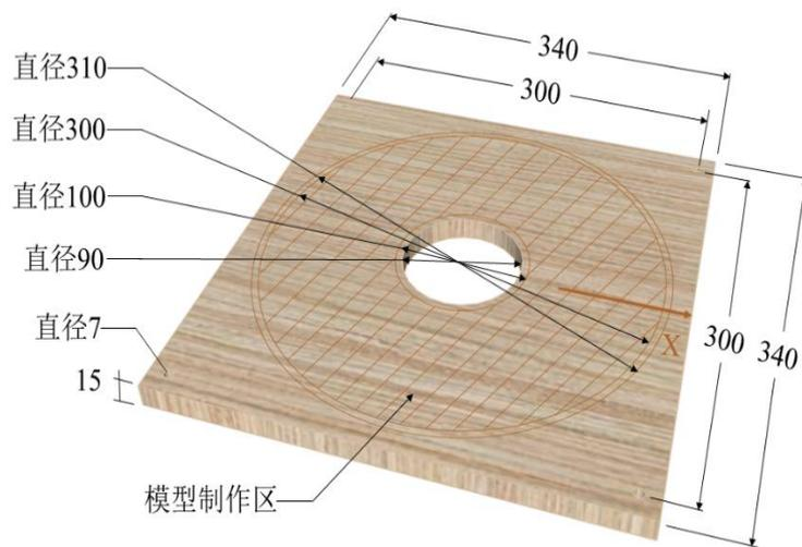
图 4 模型底板图（单位：mm）
